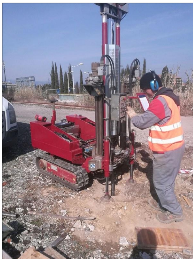
Penetrometria statica CPT5 con piezometro
